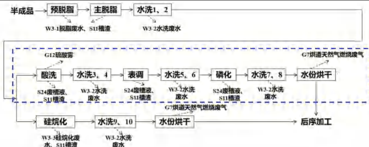
图 2-3 表面处理生产线生产工艺流程及产污环节图
